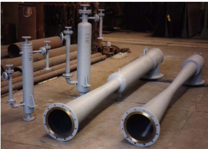
De cuatro etapas con termocompresor e intercambiadores de mezcla
