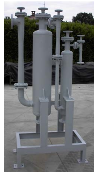
De tres etapas con condensadores de mezcla
